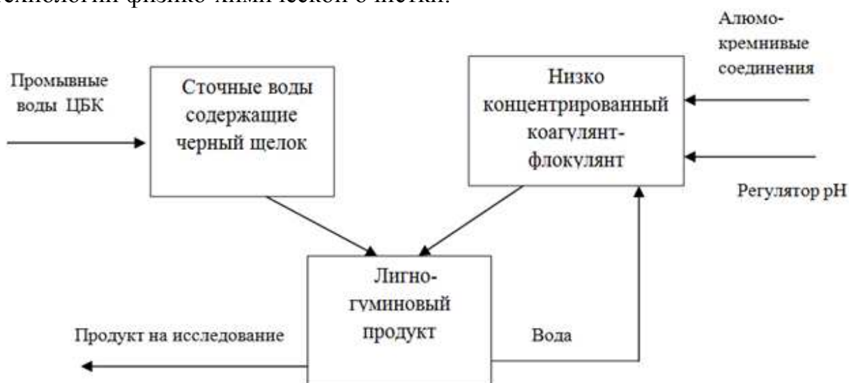
Рис.1. Схема получения лигногуминового продукта в процессе очистки воды на локальных очистных сооружениях
